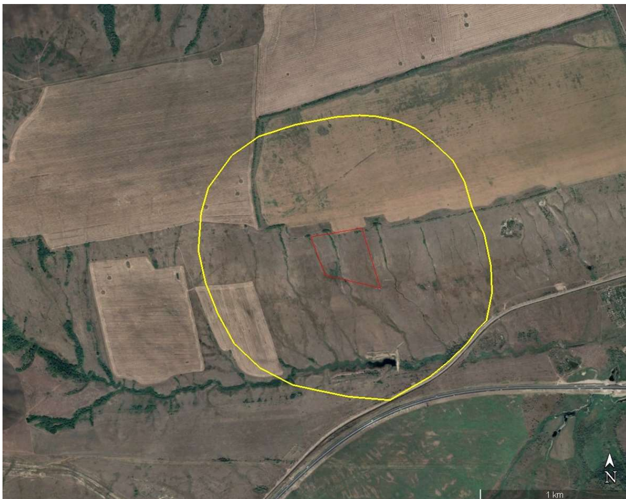
Рисунок 6 – Карта-схема размещения полигона для захоронения промышленных отходов. Красной линией выделены границы постоянного воздействия, желтой – временного
